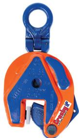
Захват IPU10 для подъема в вертикальном положении предназначен для подъема, переворачивания, перемещения или переноса в вертикальном положении листов, пластин или конструкций и их перевода из горизонтального положения в вертикальное положение (180°) и наоборот по мере необходимости. Подъемная проушина с вертлюгом позволяет укладывать и поднимать груз в любом направлении или с помощью многоветвевго стропа без бокового нагружения захвата.
