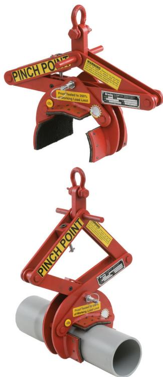
Новый регулируемый трубный захват Crosby Clamp-Co является превосходным механизмом для перемещения объектов цилиндрической формы. Новый захват имеет губки с прокладками и является превосходным механизмом для перемещения любых труб, прутков или столбов диаметром от 88,9 мм до 914 мм, особенно в случаях, когда не допускается повреждение поверхности материала.
