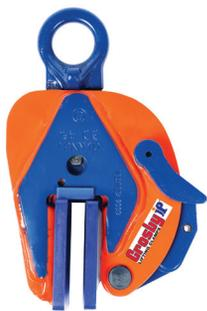
Захват IPNM10 для подъема в вертикальном положении предназначен для подъема, переворачивания, перемещения или переноса в вертикальном положении листов, пластин или конструкций и их перевода из горизонтального положения в вертикальное положение (180°) и наоборот по мере необходимости без повреждения поверхности. Возможен подъем без повреждения таких материалов, как алюминий, нержавеющая сталь, окрашенные материалы, обшивка самолетов, композитные материалы, стекло, пластмасса и т. д.
