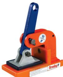
Захваты IPHNM10 для подъема в горизонтальном положении оснащены механизмом преднатяжения, позволяющим пользователю закрепить захваты на материале для подъема и переноса в горизонтальном положении не прогибающихся материалов. Для использования в случаях, когда не допускается повреждение поверхности материала. Эти захваты должны использоваться в количестве не меньше двух.
