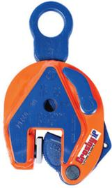
Захват IP10 для подъема в вертикальном положении предназначен для подъема, переворачивания, перемещения или переноса в вертикальном положении листов, пластин или конструкций и их перевода из горизонтального положения в вертикальное положение (180°) и наоборот по мере необходимости. Обычно используется как одинарный захват или с траверсой в составе системы вертикальных захватов.
